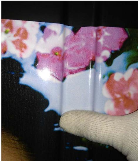
9. Alternativamente, al posto dell'applicazione manuale, possono essere utilizzati dei rulli manuali studiati appositamente per tale lavorazione. I rulli manuali permettono al film di essere applicati con pressione uniforme e continua e con basso frizionamento.
