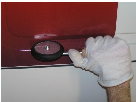
11. Utilizzando l'applicazione manuale o i rulli 3D, scaldare il film approssimativamente a 50°C e continuare applicando il film sulla parte piana della corrugazione fino a quando non si arriverà ad avere un canale d'aria leggero tra film e l'angolo della corrugazione.
