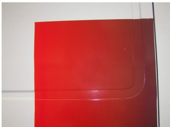
8. Partire con l'applicazione nel punto più profondo della corrugazione (1). Poi proseguire fino al lato opposto della corrugazione (2). Poi premere la parte centrale della corrugazione (3).
